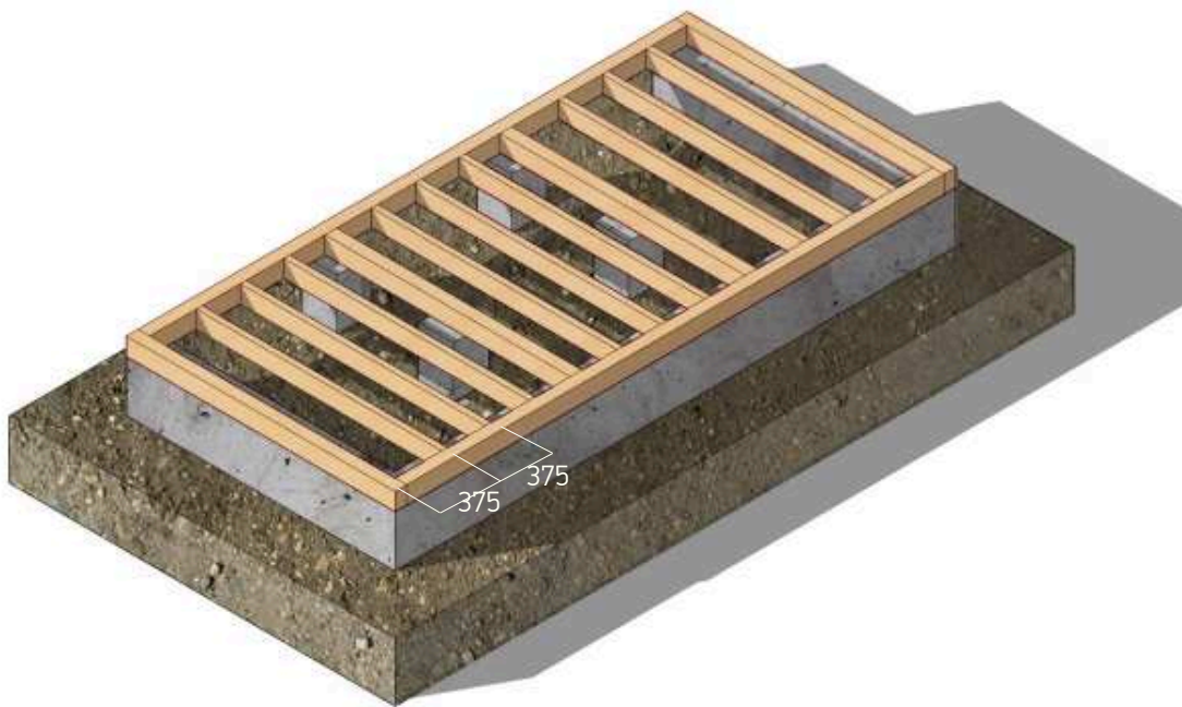
Деревянный каркас из бруса 100x150 на ленточном фундаменте.
